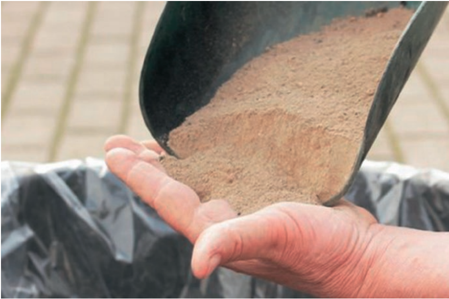
Das bei der Aufbereitung des Klärschlammes gewonnene phosphorhaltige Endprodukt kann einer Phosphor-Rückgewinnung zugeführt oder direkt als Anwendungshilfsmittel eingesetzt werden.
